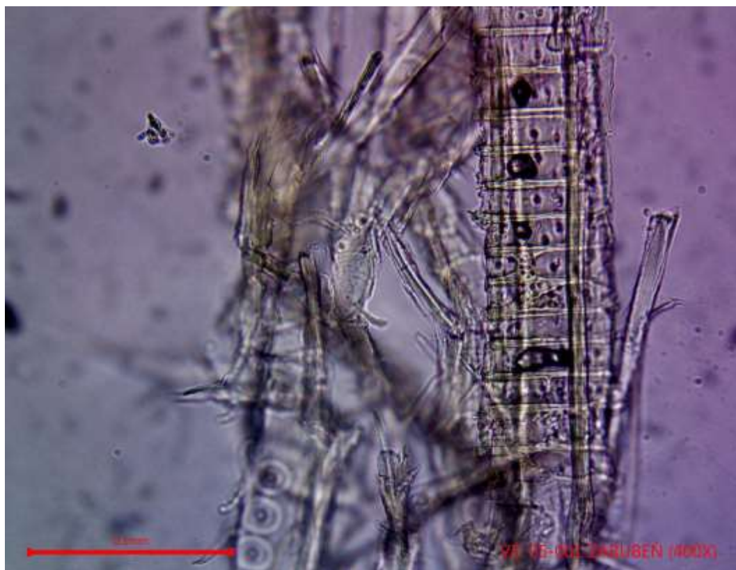
Mikroskopie dřeva, dveře na WC, vzorek 05-001
