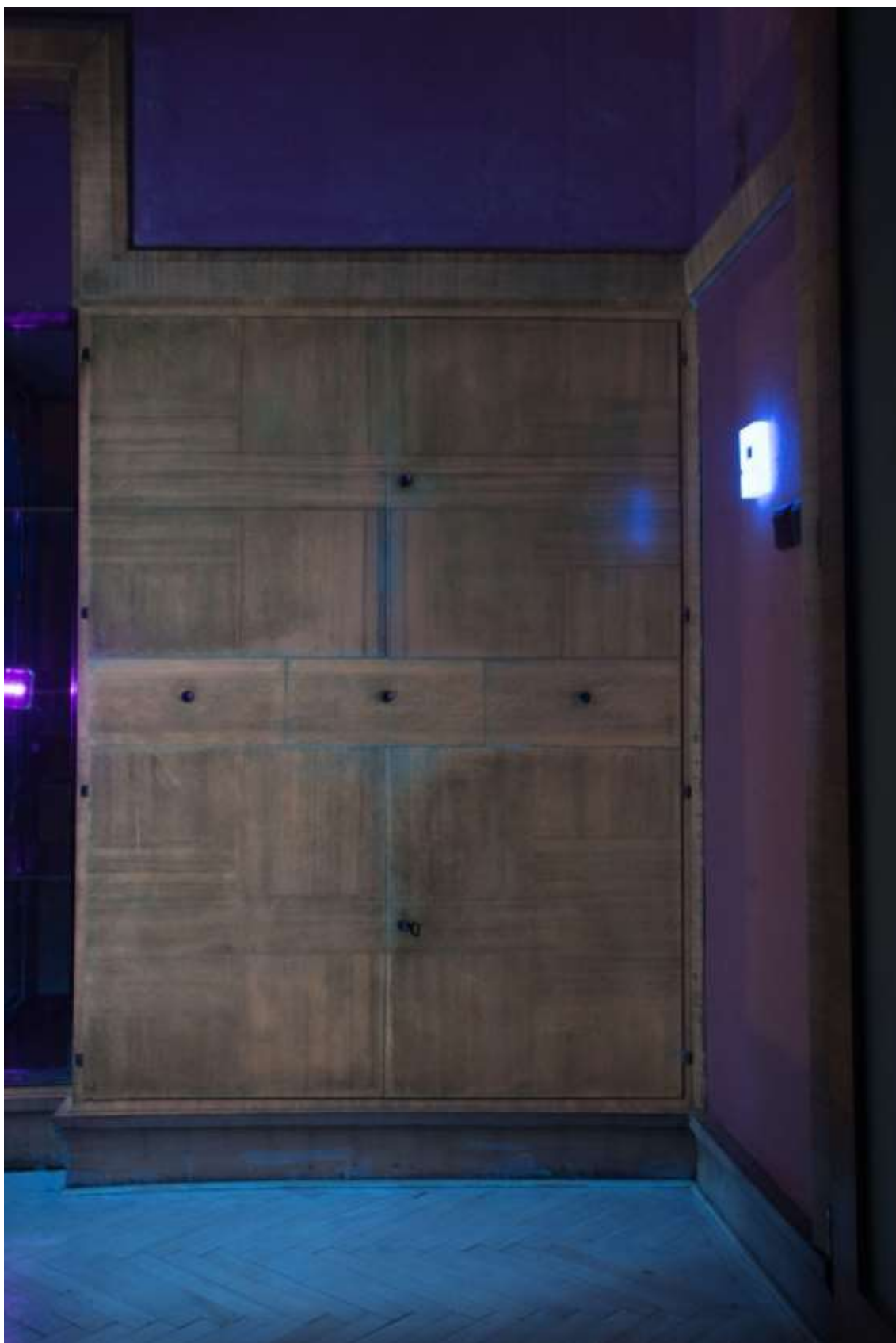
Levá skříňka, modrá fluorescence na místech, kde docházelo k častému kontaktu rukou.
