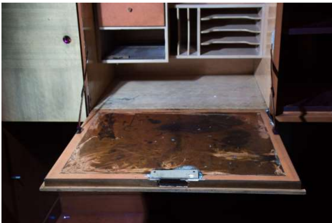
Detail sekretáře, znečištěná výklopná deska, oranžová fluorescence okrajů výklopné desky
