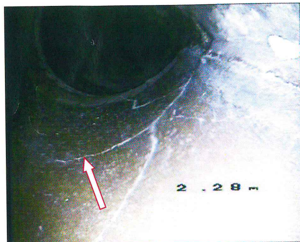
FOTO 005: 1,3m - netěsnost, paprskovité trhliny, celkový obvod, exfiltrace
