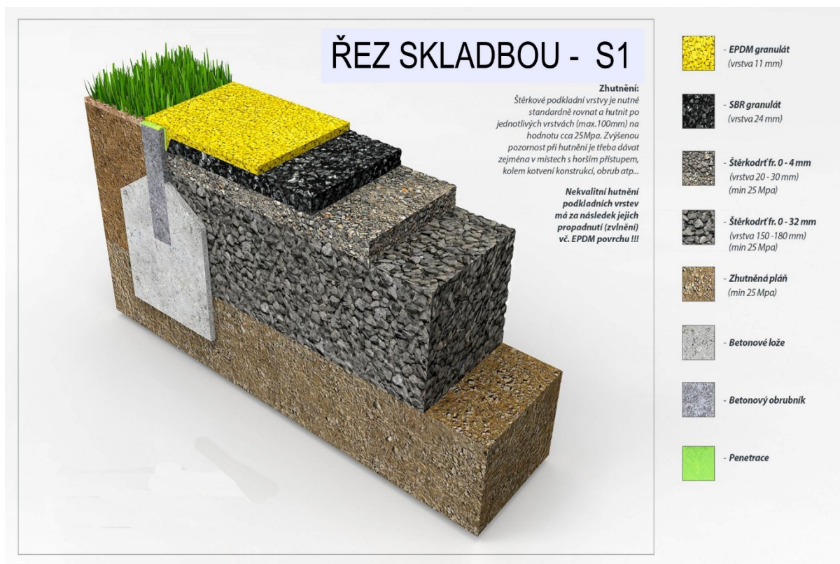
řez souvrstvím víceúčelového hřiště v případě nevyužití stávajících podkladních vrstev (konkrétní řešení bude navrženo zhotovitelem)
