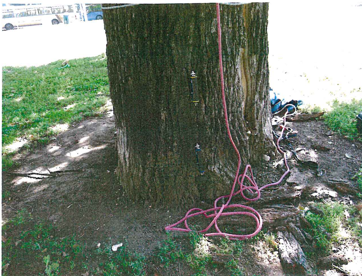
Obr. 5: Pozice přístrojů na kmeni při tahové zkoušce
