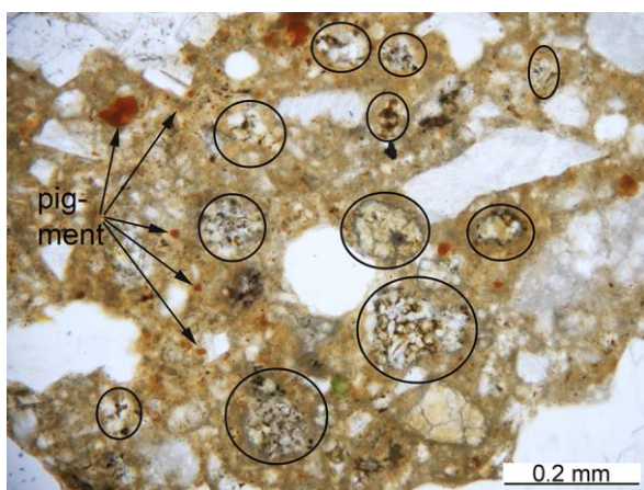
17: Vzorek C – portlandský slínek (zakroužkováno) a pigment; PPL
