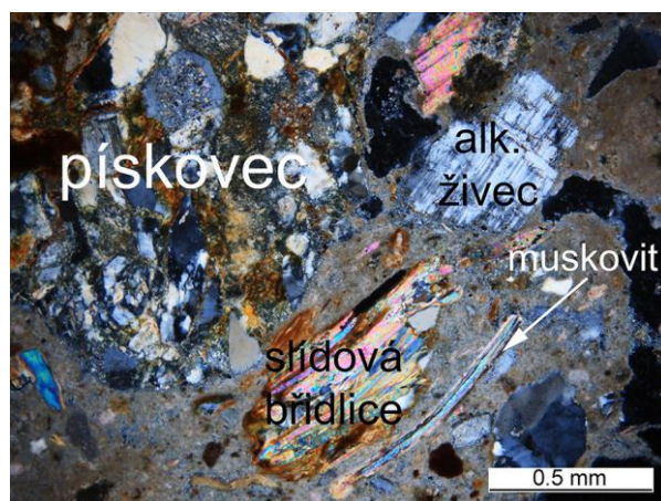
Obr. 14: Vzorek B2 – plnivo; XPL
