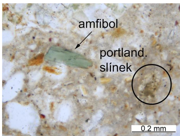
Obr. 12: Vzorek B2 – plnivo, pojivo a pigment; PPL
