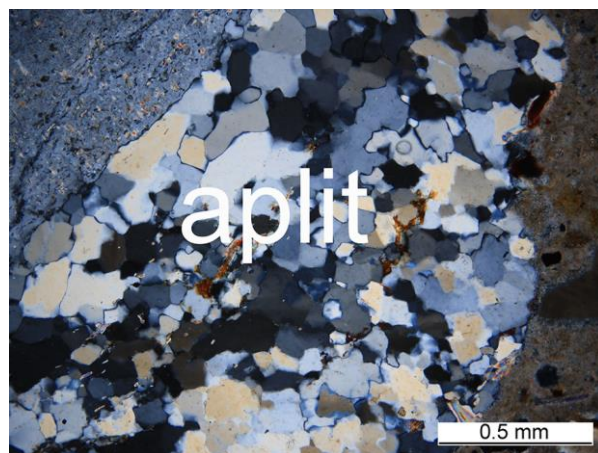
Obr. 15: Vzorek B2 – plnivo; XPL
