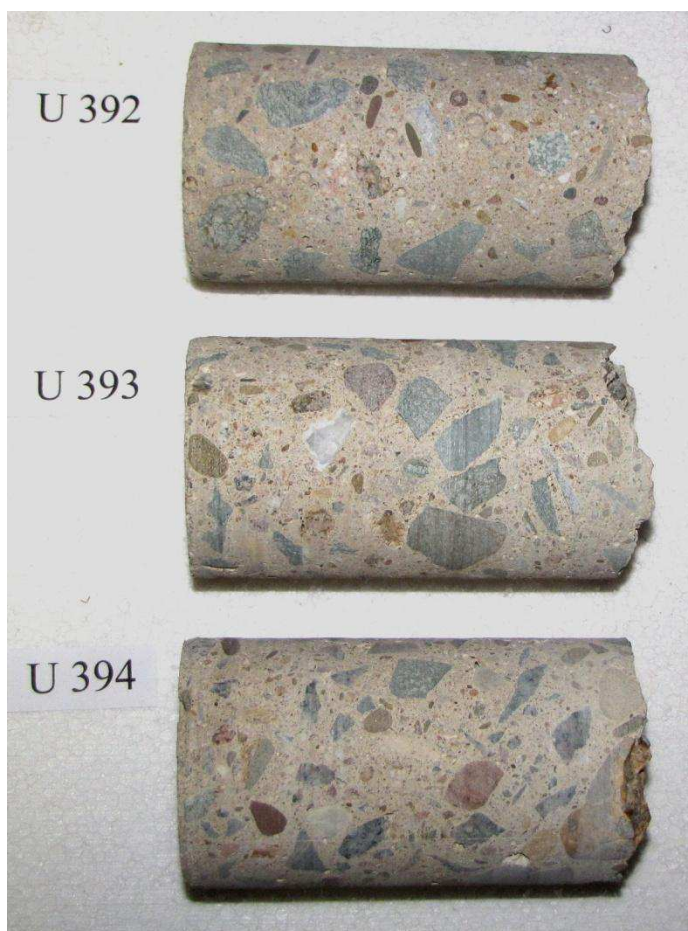
Obr. 1.: Vývrtky z betonu po dodání do laboratoře.
