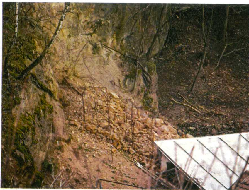
Obr. 9. Napadaný kamenitý materiál z horní části skalní stěny objektu svahové nestability 25-34-04/3b. Foto O. Krejčí 25. 3. 2019
