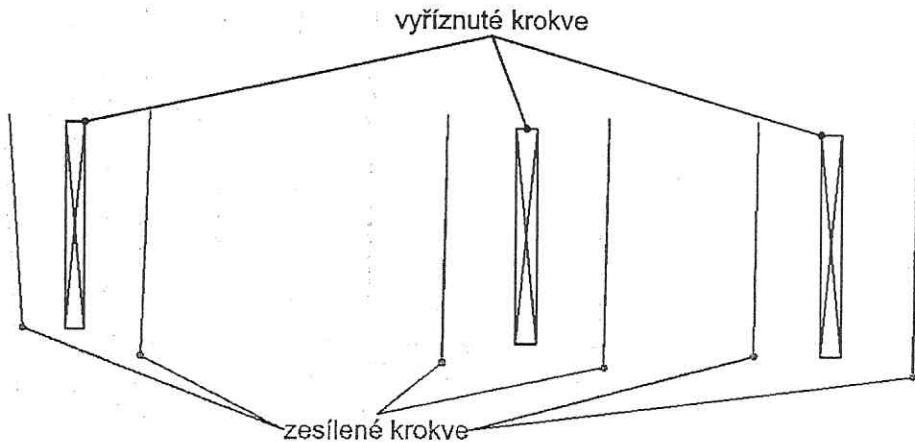
Skládaná pálená krytina bude přeložena a nově budou provedeny vrstvy střechy tak, aby vyhovovaly novému účelu podkroví. Z interiéru bude krov zpevněn dřevěnými lisovanými deskami. Dá se předpokládat, že tak dojde k mírnému zvýšení únosnosti krovu.
