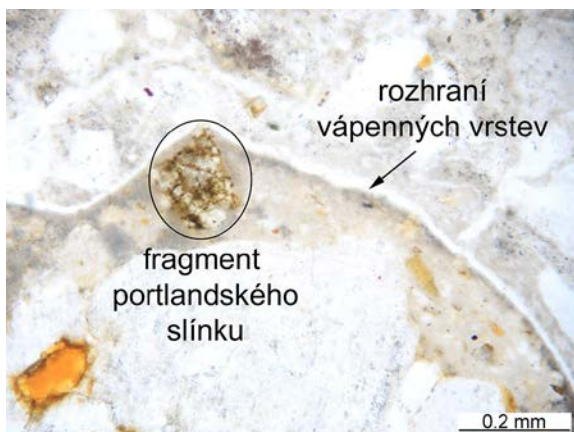
Obr. 4: Vzorek H-rozhraní vápenných vrstev a portlandský slínek; PPL
