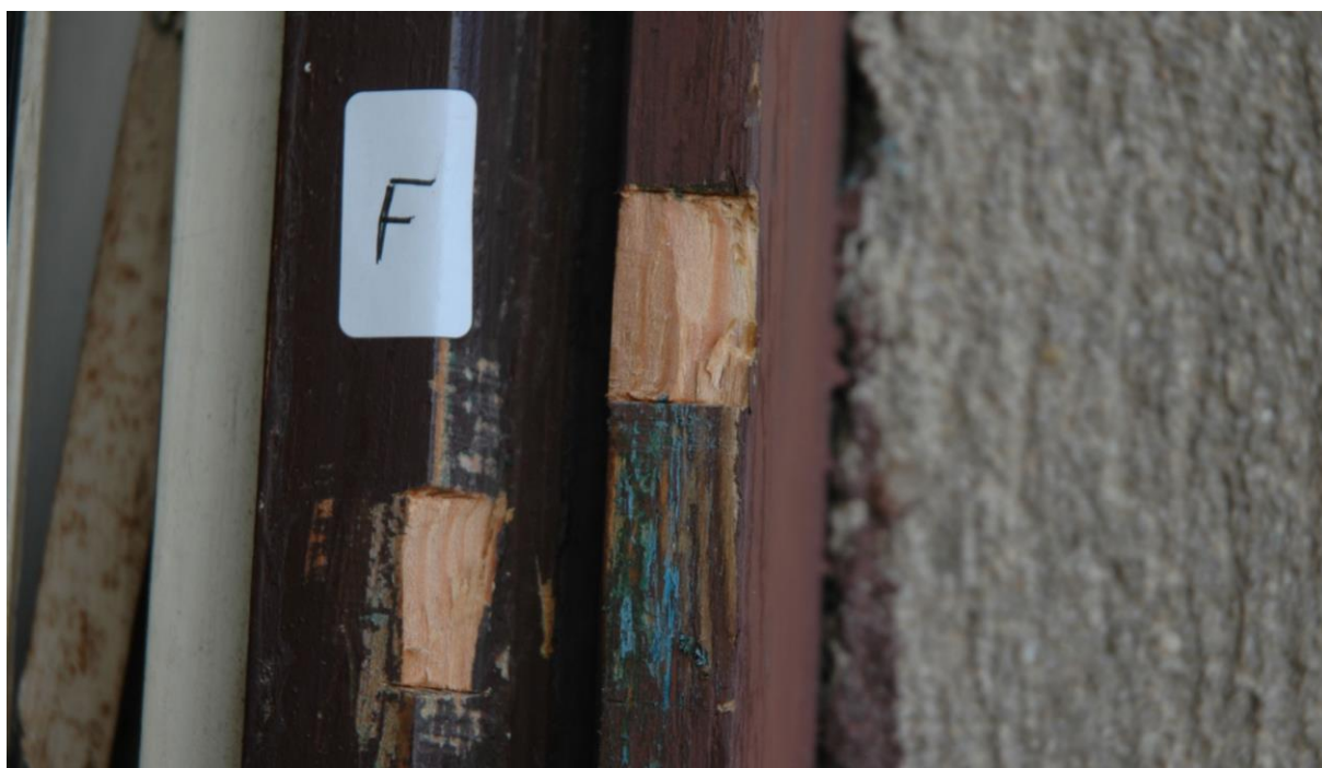
Místo odběru vzorku F – profilace okenního rámu
