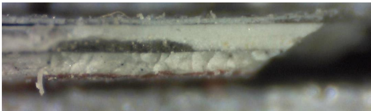
Vzorek II - výstavba povrchových úprav při makroskopickém zvětšení
