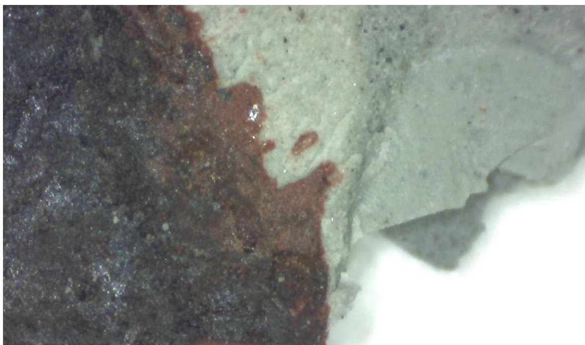
Vzorek I2 - povrchové úpravy zábradlí při makroskopickém zvětšení – pohled zespodu
