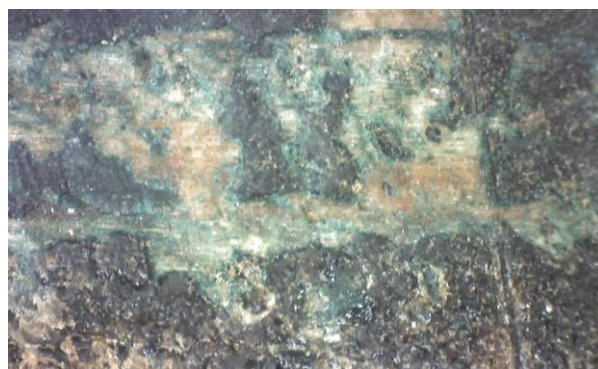
Vzorek B2 výstavba povrchových úprav při makroskopickém zvětšení (řez a pohled s hora)
