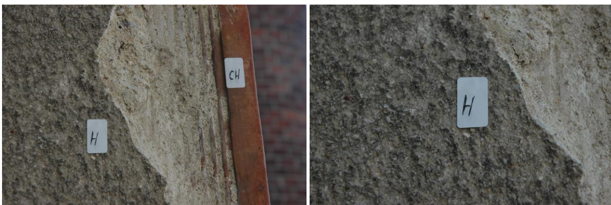
Na fotografiích je místo odběru vzorků H a CH, které byly předmětem materiálové analýzy (viz samostatná příloha. Petrografická a rtg-difrakční analýza, Mgr. D. Všianský).
